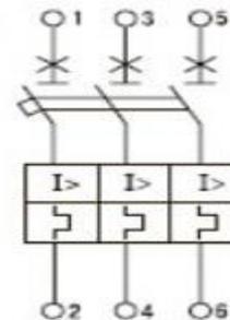
с тепловым и электромагнитным расцепителем
